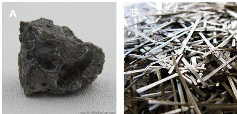
Figura 24: A- Rocha de basalto; B- Fibra de basalto.
