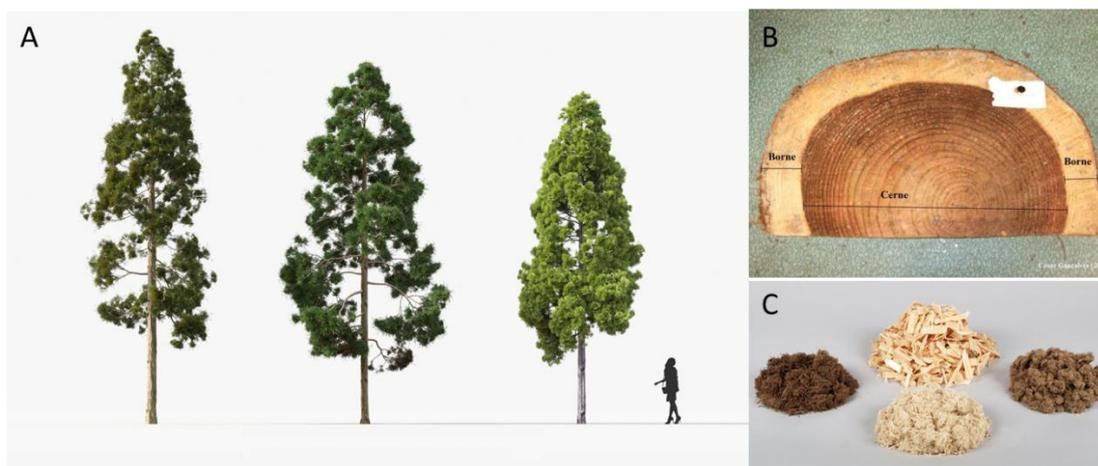
**Figura 19: A- Ilustração da criptoméria japónica e sua dimensão relativa. B - Secção transversal do tronco, com identificação do cerne e do borne; C: Ilustração exemplificativa das fibras da madeira**
